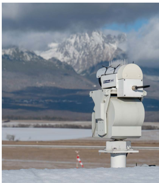
Ejemplos de cámaras visuales e infrarrojas con rotación habilitada
